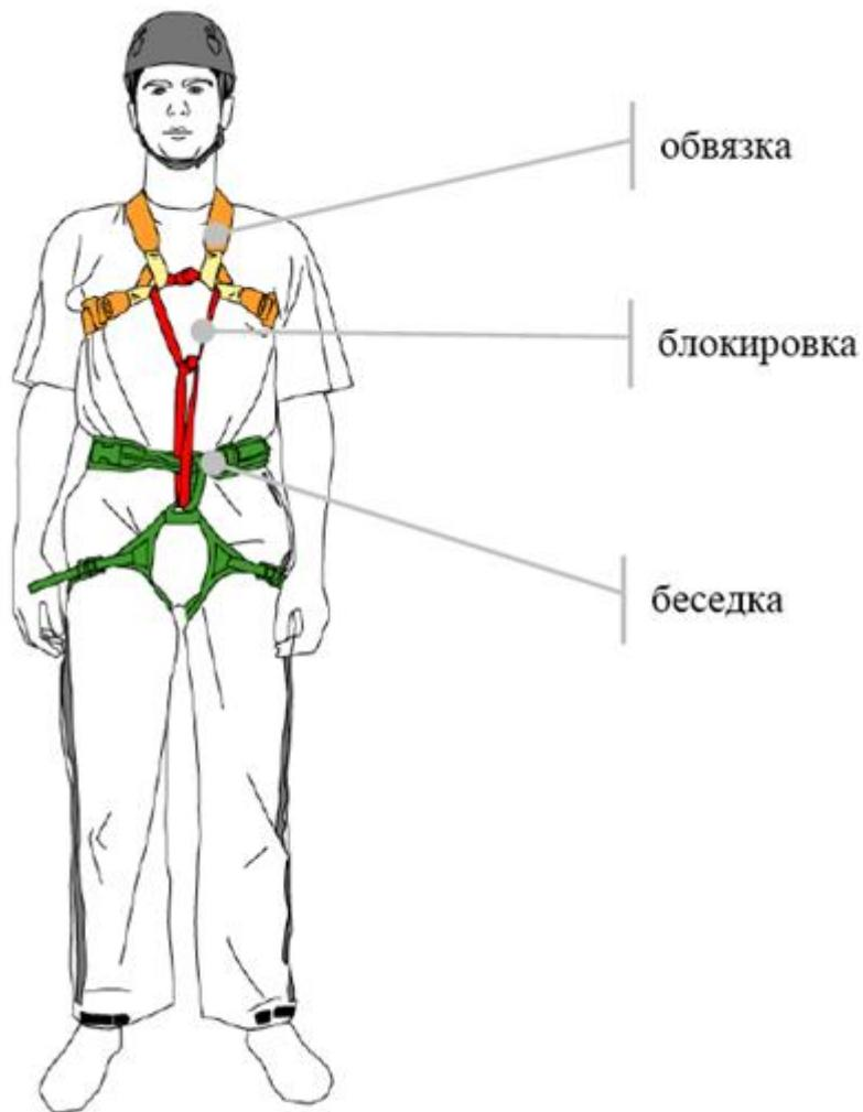
Индивидуальная страховочная система (ИСС) — элемент снаряжения, предназначенный для обеспечения безопасности в случае срыва и зависания на веревке (в отличие от страховочного монтажного пояса, который только предотвращает падение, но не обеспечивает безопасность при срыве). ИСС состоит из двух элементов: верхней (грудной) обвязки и беседки, соединенных между собой блокировочной веревкой.
