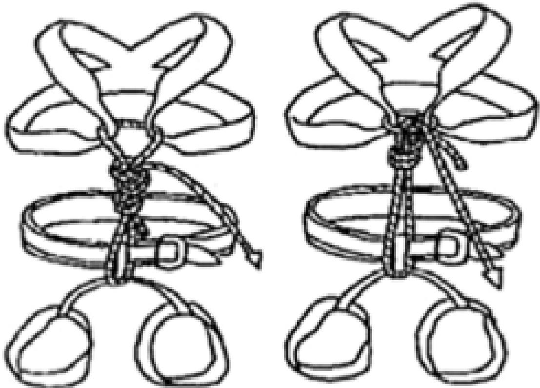
В раздельных ИСС беседку и грудную обвязку требуется соединять (блокировать) при помощи веревки. Для блокировки применяют основную веревку или специальную стропу. Нельзя блокировать обвязку репшнуром, карабином.
