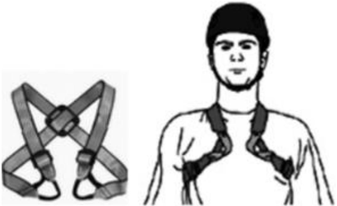
*Верхняя, или грудная, обвязка* служит для поддержания вертикального положения тела человека, работающего на веревке.
