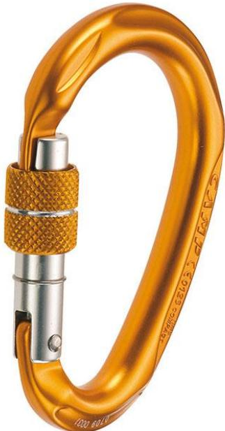
**Грушевидная и HMS.** Преимущество — большое открытие, что делает его удобным при работе с несколькими верёвками или устройствами. В него влезут и правильно расположатся несколько узлов. Такой карабин характеризуют треугольная форма и толстый пруток. HMS — название тормозного узла. Чаще всего используются на станциях, для спусковых устройств, там, где возможно высокое постоянное трение верёвки о карабин. Трение верёвки о карабин стараются
