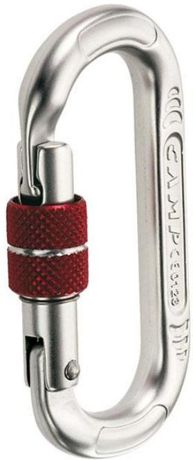
**Симметричная форма (овал).** Преимущество — расположение верёвок и устройств по центру симметрии карабина, в его середине. Овалы незаменимы при использовании с роликами и другим снаряжением, требующим центровки.
