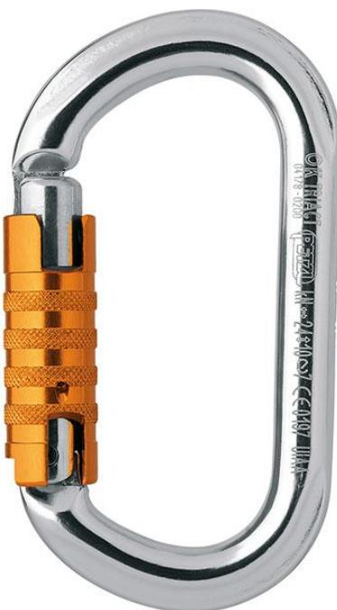
Более надёжные карабины — триактевые. Автоматическая муфта, открывающаяся на три движения — муфту опустить вниз, повернуть в сторону, и только потом можно открыть карабин. Такая конструкция была разработана в первую очередь ради обеспечения дополнительной безопасности в промальпе. Для альпинистов неудобно в условиях холода открывать и закрывать его в толстых
